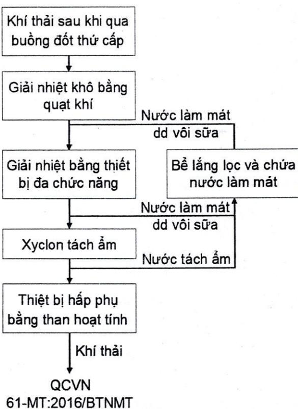
Khí thải sau khi qua buồng đốt thứ cấp được dẫn tới thiết bị giải nhiệt khô, với mục đích hạ nhiệt từ buồng đốt từ 950°C xuống dưới 600°C. Lượng khí thải tiếp tục được giảm nhiệt độ nhanh bằng thiết bị đa chức năng. Tại đây thiết bị thực hiện 2 nhiệm vụ là khử bụi ẩm và hạ nhiệt độ (dùng các béc phun dung dịch sữa vôi để làm sạch tro và khử khí có tính axit).
